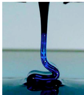
Figure Ccl- 3 : Flambage visqueux d'un filet liquide de sirop de glucose (viscosité \eta=120 cP) engendré par sa décélération à l'approche d'un substrat. Photographie N. RIBE.
