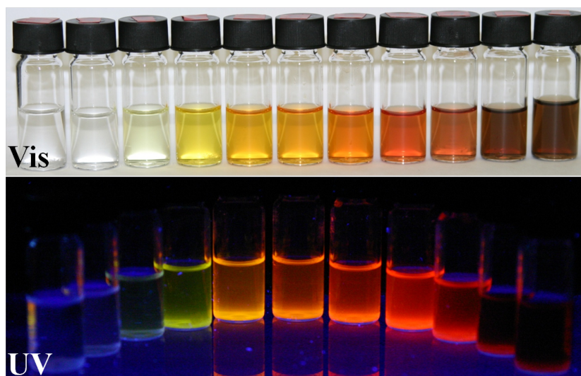
FIGURE IV.3 – Nanocristaux colloïdaux \text{CuInS}_2 dans l'hexane à différentes étapes après l'injection du précurseur de soufre. En haut, en lumière visible (absorbance), en bas, illumination sous lumière ultra-violette (fluorescence).
