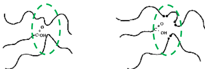
Figure I. 34: Influence de la terminaison des chaînes sur l'hydrolyse des groupements esters voisins [109]
