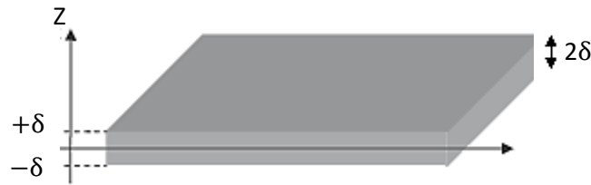
Figure I. 31: Illustration des conditions aux limites pour le modèle de Carter et Kibler [98]
