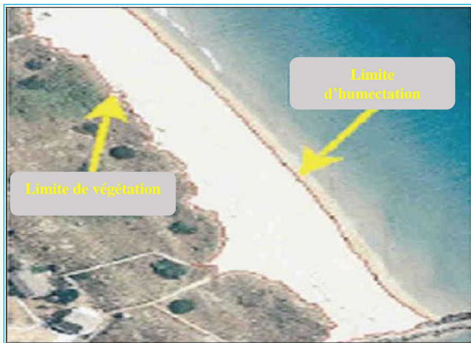
Figure 28. Variations de couleur marquant la limite d'humectation ou la limite de végétation sur une photographie aériennes en couleur (Source : Hoeke et al., 2003 ; modifié)
