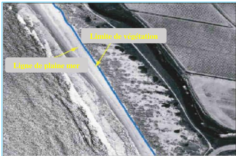
Figure 27. Variations de contraste indiquant la ligne de pleines mers ou la limite de végétation sur une photographie aérienne panchromatique (Source : Moore et Griggs, 2002 ; modifié)
