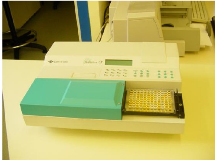
Figure 8 : Un spectrophotomètre relié à un ordinateur
