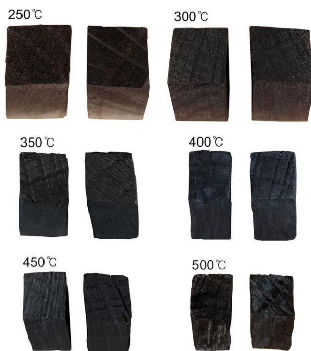
Figure I-34- Changement de couleur de blocs de chêne carbonisés sous atmosphère inerte à plusieurs températures (Kwon et al., 2009).
