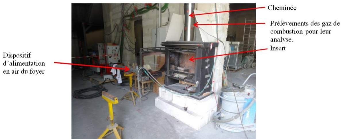
Figure II-46- Système de carbonisation expérimental installé au CSTB.
