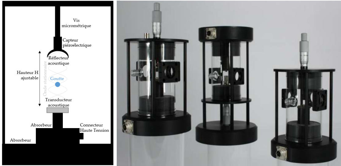
Figure 42 : Schéma de principe et quelques photographies des différents lévitateurs acoustiques Tec5.
