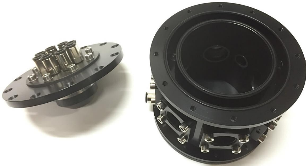
Figure 55 : Photographies de la chambre d'évaporation avec, à gauche, son couvercle intégrant l'aspiration axisymétrique (imprimé en 3D inox) et, à droite, le corps principal avec fenêtres optiques et double paroi.
