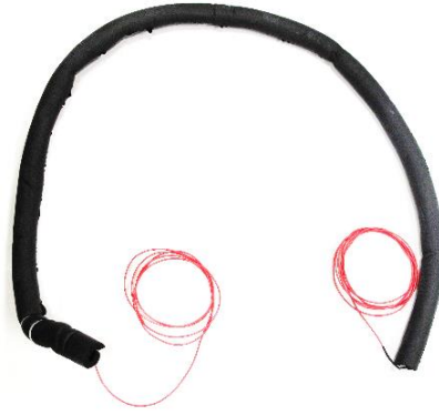
Figure 58 : Photographie du système de tuyau chauffant : l'air humide circule dans un tuyau (non visible) résistant à haute température qui est entouré d'un fil de Kanthal (en rouge) assurant le chauffage et d'une gaine d'isolation thermique et électrique (en noir). Le thermocouple de contrôle n'est pas visible sur cette photographie.
