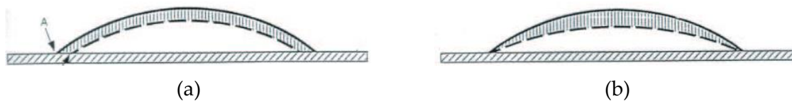
Figure 19 : Illustration du séchage sur un substrat dans le cas d'une goutte (a) d'eau pure, la base de la goutte rétrécit au cours du séchage, (b) d'une suspension concentrée en particules colloïdales, la ligne triple de raccordement substrat-solvant-air est fortement ancrée sur le substrat (Pauchard et al. [50]).
