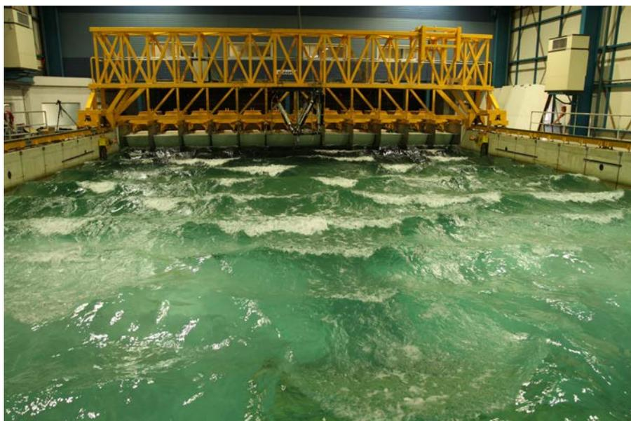
Figure VII.14 – Illustration du déferlement de la houle dans le bassin. Condition U2 T2 H2.
