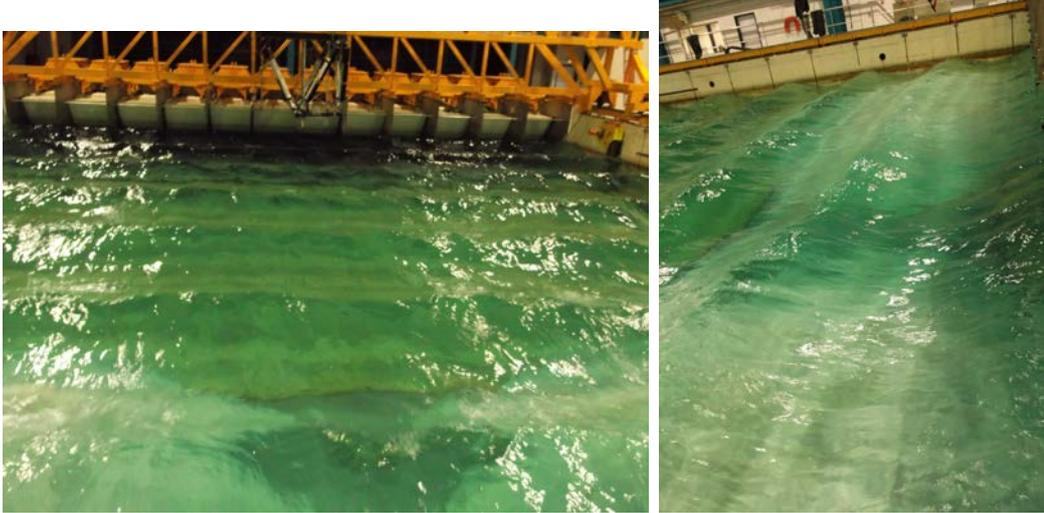
**Figure VII.22** – Phase de la houle en amont des bosses (à gauche) et sur les bosses (à droite) pour les conditions hydrodynamiques  $U_1, T_1, H_2$ .
