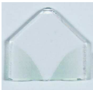
FIG. 4.7 – Cristal de KDP de 12 \times 12 \text{ cm}^2 de section, dont la solution de départ a été dopée avec 5 ppm de chrome. [67].
