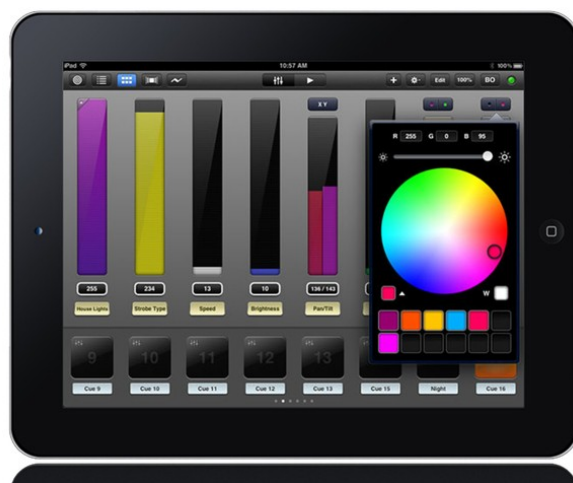
Figure 39: L'application Luminair permet de piloter à distances certains projecteurs LED. Tout est modulable : niveau, température de couleur, teinte, saturation. © Image Credit Luminair
