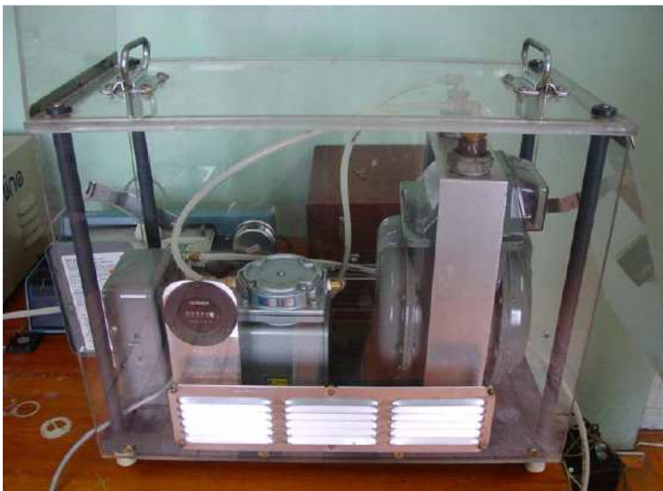
Figure 4.2.Éléments constitutifs de l'échantillonneur d'air GENT.
