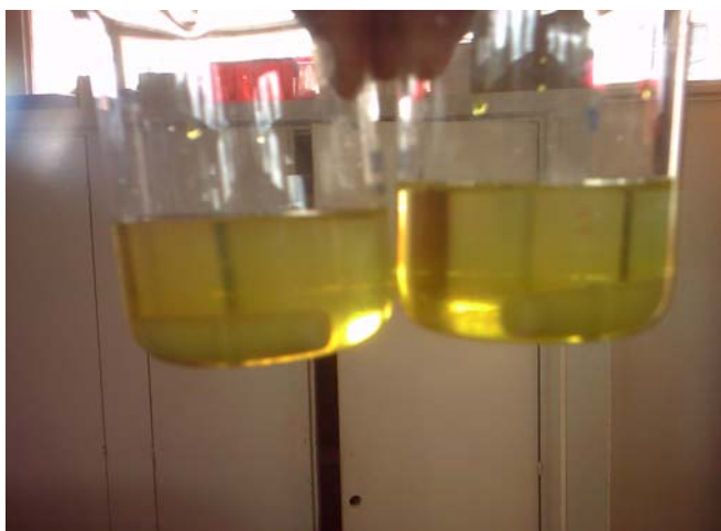
Photo 6 : Teneur en chlore dans les deux couches à gauche le couche jaune et à droite la couche blanche
