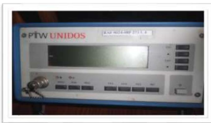
**Figure 10 :** Electromètre
