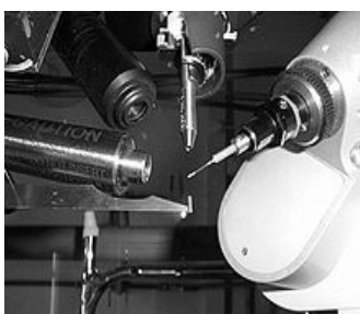
Figure 10-5 : Appareil utilisé pour analyser un monocristal
