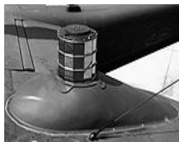
Figure11-5: Détecteur d'émetteurs d'infrarouge, le plus souvent un missile à guidage de ce type, posé sur un avion militaire, ici un OV-10 Bronco
