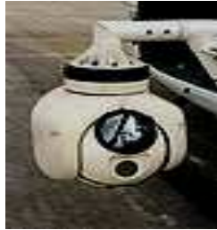
Figure 11-4 : Caméra infrarouge de type FLIR (Forward Looking Infrared Radar), montée sur un hélicoptère UH-1 Huey
