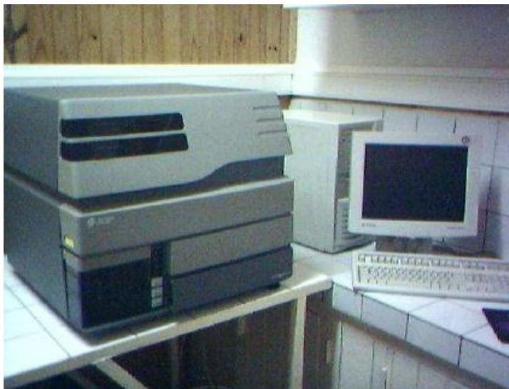
Figure 10: Epics XL, Beckman Coulter. Cytomètre à 4fluorescences équipé d'un laser 488 nm équipé de plusieurs photomultiplicateurs capables de détecter quatre longueurs d'ondes d'émission différentes. FITC (Isothiocyanate de fluorescéine) émet en FL-1 à une longueur d'onde de 505-545nm, RD1/PE (Rhodamine couplé à la phycoérythrine) en FL-2 de 560-590 nm, ECD (Phycoérythrine-Texas Red -X) en FL3 de 605-635 nm, PC 5 (Phycoérythrine-Cyanine 5,1) en FL4 de 660-700 nm. (Source : IPM)
