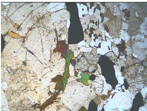
Fig.9 Microphotographie (X5) DN12 d'un granite à biotite du Col de Manangotry,
