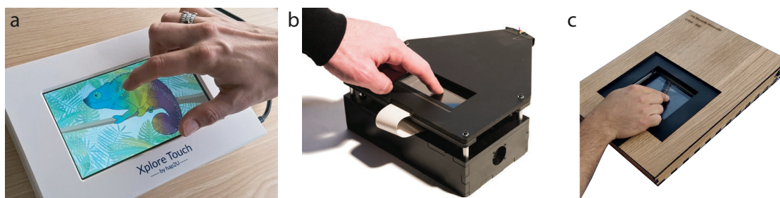
FIGURE 2.17 – a. Xplore de Hap2U™, b. Interface haptique à une dimension avec capteur de position optique issu de (Wiertlewski et al., 2014b), c. Interface haptique à deux dimension avec capteur de position optique issu de (Huloux et al., 2018a)
