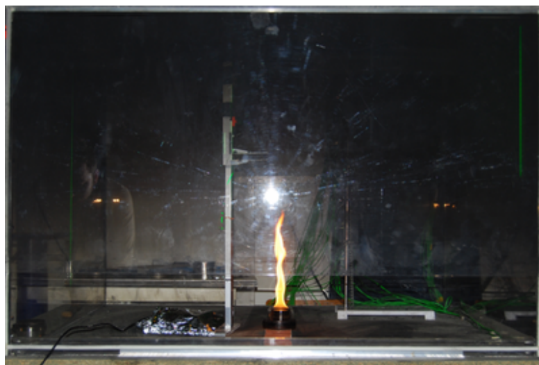
FIGURE 4.10 – Photographie de la face avant du réservoir de fumée et de la flamme du foyer.
