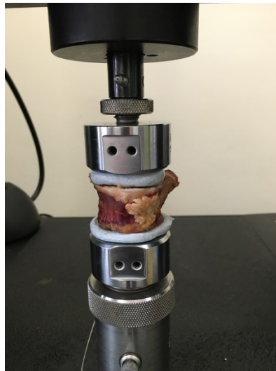
Fig 1 : Machine d'essai de compression avec échantillon vertébral.
