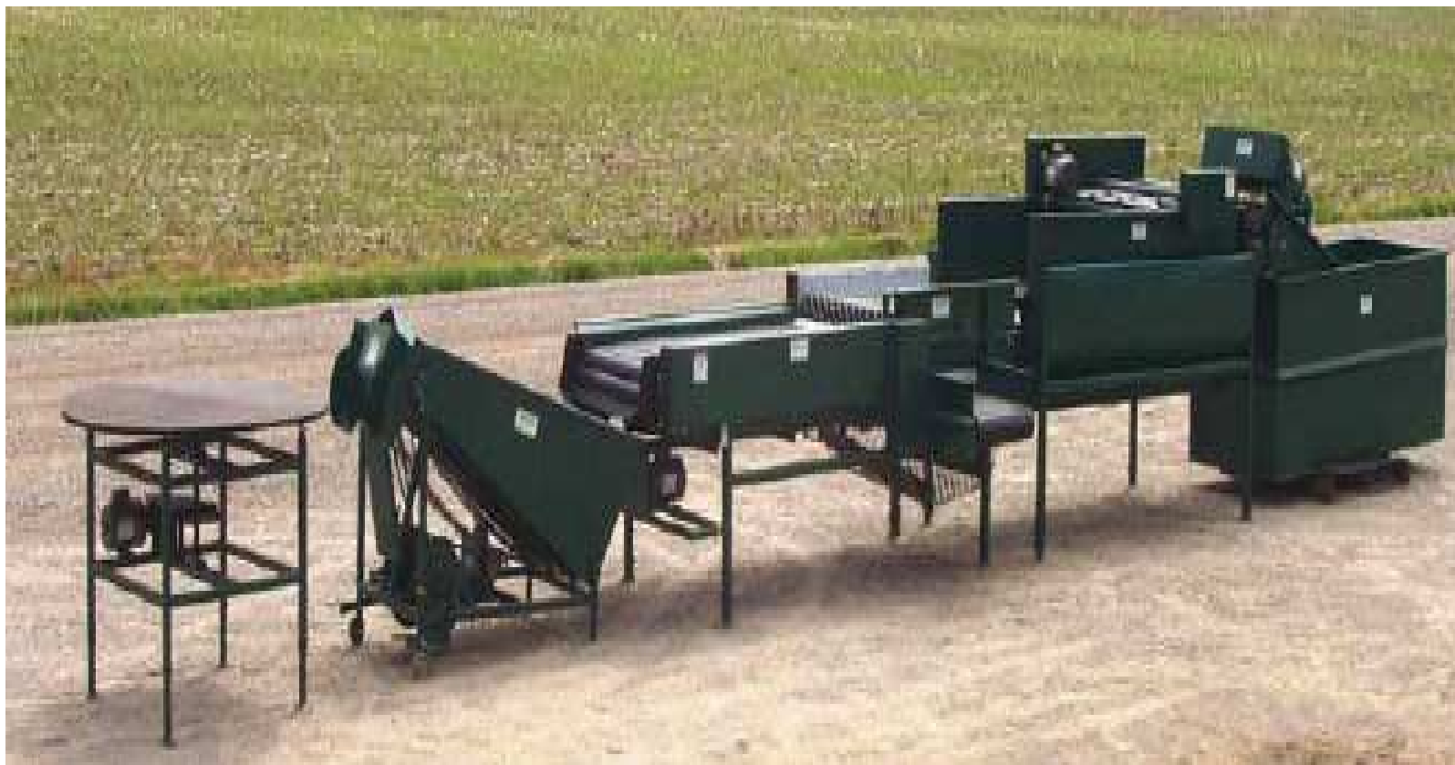
Figure n°25 : schéma d'un calibreur pour pomme de terre Source : FERTILIS in [BAMEX, 2005]
