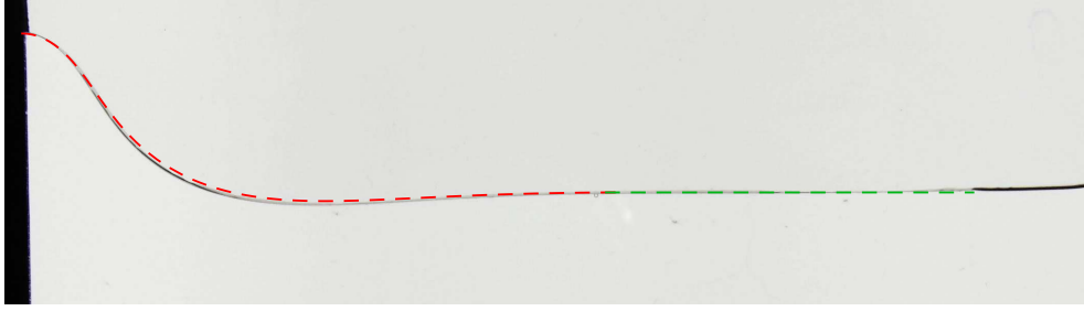
FIGURE 4.16: Comparaison entre une image expérimentale et une solution théorique, dans le cadre d'une configuration d'équilibre d'une lamelle avec \ell \gg 1 (ici \ell = 12.2 ). La solution théorique est composée de la solution interne (rouge) obtenue numériquement à partir de l'équation (4.42) avec h = 1.91 et \zeta = 0.24 , et de la solution externe (verte) donnée par l'équation (4.39).
