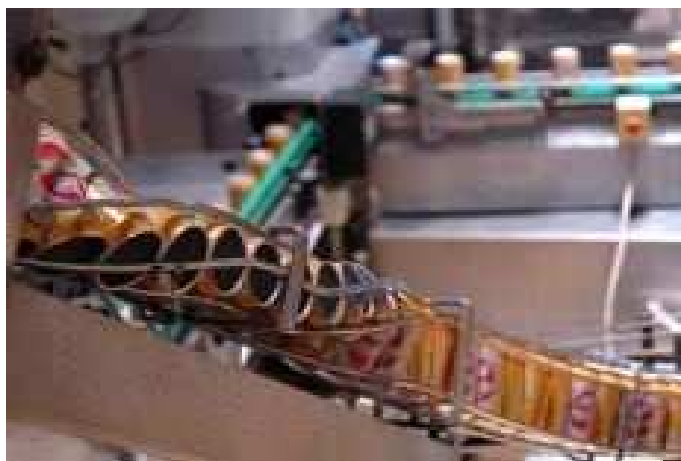
Figure n ° 15 : le processus de conditionnement de la THB Pilsener en canette
