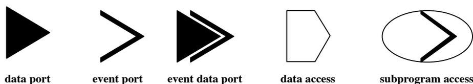
FIGURE 10 – Syntaxe graphique des éléments d'interface d'une spécification AADL
