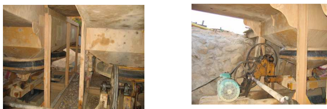
Photo n°12: Le système du jiggeage
