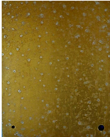
FIGURE 5.6 – Photo d’une éprouvette d’alliage 2618 ayant subi une gamme référence de traitement de conversion au chrome hexavalent de MBD (Messier-Buggatti-Dowty), après 24h d’exposition au brouillard salin neutre. Tous les points blancs correspondent à la formation de piqûres traduisant la corrosion de la pièce
