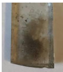
Figure 3 : Photo du dépôt de NiO en milieu éthanol après un recuit à 300^\circ\text{C}/30\text{ minutes}
