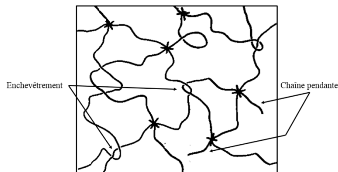
Figure 11 – Réseau réticulé et enchevêtré contenant des chaînes actives et pendantes [18]
