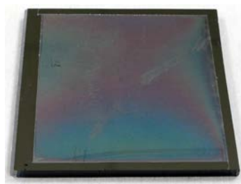
Figure 3.5. : Aperçu macroscopique d'un échantillon de ZnO électrodéposé sur un substrat verre/Mo ( 5 \times 5 \text{ cm}^2 ) à [Cl^-] = 200 \text{ mM} .
