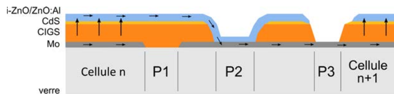
Figure 5.1. : Intégration monolithique des cellules solaires de type CIGS utilisée notamment par le ZSW.
