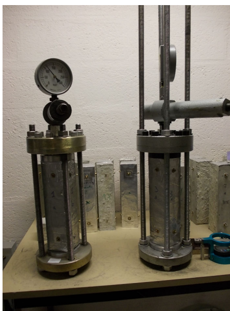
FIGURE 4.26: Bâtis de fluage en compression
