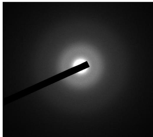
Figure 4.31 : A gauche : Figure de diffraction d'un dépôt de  $MgSiO_3$  réalisé par pulvérisation cathodique magnétron. A droite : Signal de diffraction obtenu d'un dépôt de  $MgSiO_3$  réalisé par pulvérisation cathodique magnétron analysé au MET.
