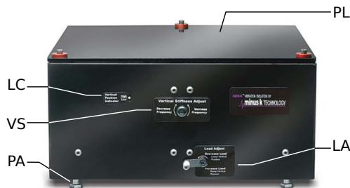
(b) Plate-forme d'isolation vue de côté. PA : pieds ajustables, LA : ajustement de la charge, VS : contrôle de la raideur verticale, LC : témoin de charge, PL : plateau de support. Adapté de http://www.minusk.com .
