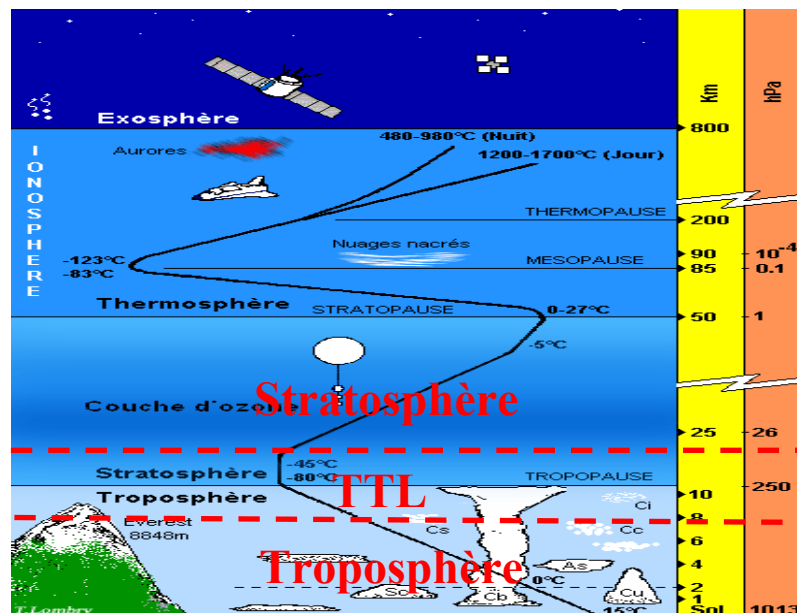
Figure 1. Profil vertical de température en atmosphère standard. Du sol à 12-17 km, se situe la troposphère (gradient thermique négatif). La stratosphère est comprise entre ce niveau et 50 km (gradient thermique positif). TTL en rouge (Tropical Transition Layer), zone de transition entre la troposphère et la stratosphère aux tropiques.
