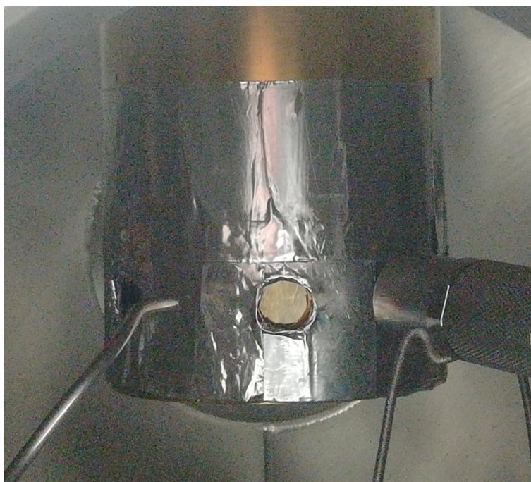
Figure 2.9 : Photographie du porte échantillon contenant les miroirs et englobé par l'écran thermique situé à l'intérieur de la chambre.
