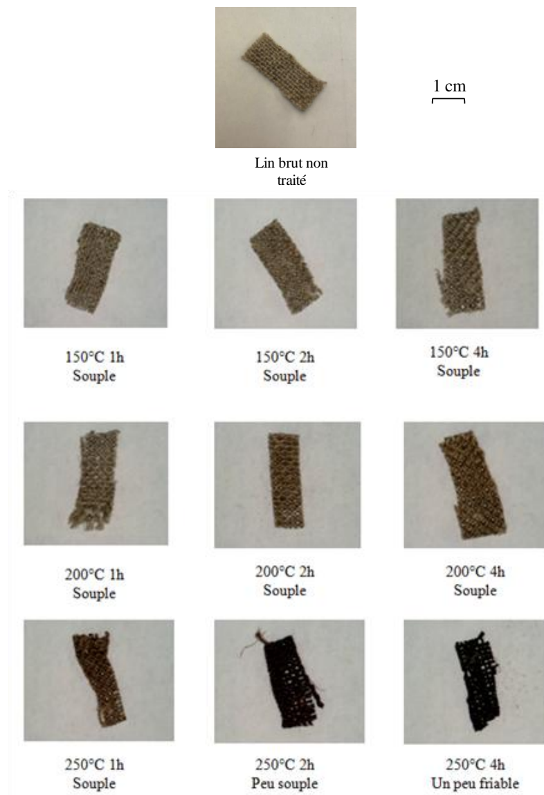
Figure 3-13 : Photographies (Dino-Lite) des échantillons de lin moderne chauffés à 150, 200 et 250°C pendant 1, 2 et 4h et mention qualitative de la texture observée après traitement.
