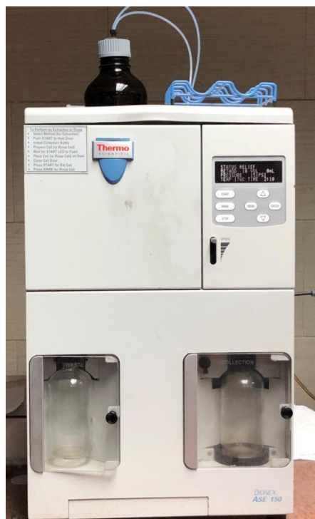
Figure A-33 : Photographie de l'appareil Dionex 150 (Thermo Scientific) pour ASE (extraction accélérée par solvant)
