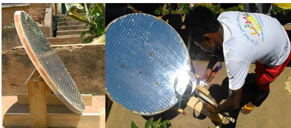
Figure 30 : Concentrateur solaire avec le panneau de la marmite.
