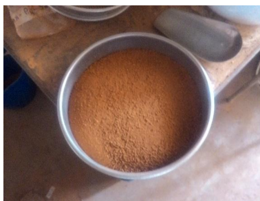
Photo 2 : Sol broyé et tamisé à 0,2mm
