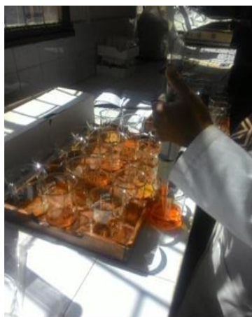
Photo 5 : Oxydation de la matière organique et dosage du mélange avec l'appareil CRISON
