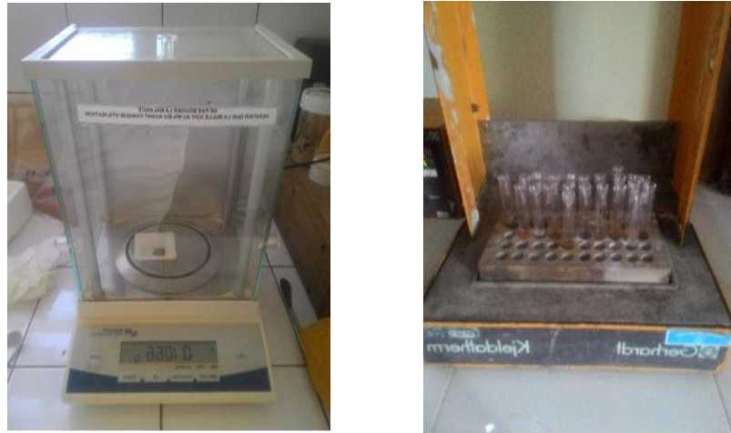
Photo 6 : pesage des échantillons et libération de l'azote minérale
