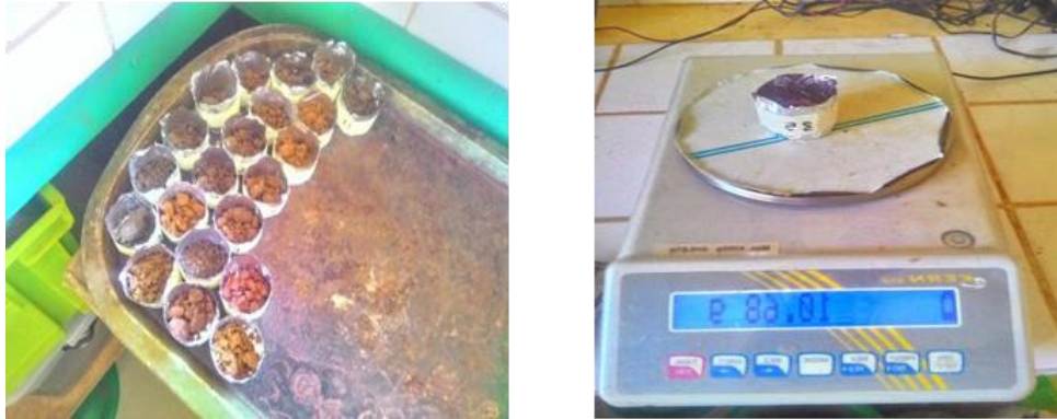
Photo 3: Détermination de l'humidité des échantillons de sol
