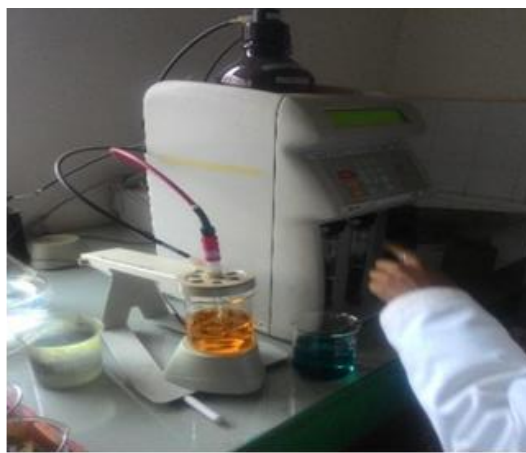
Photo 5 : Oxydation de la matière organique et dosage du mélange avec l'appareil CRISON
