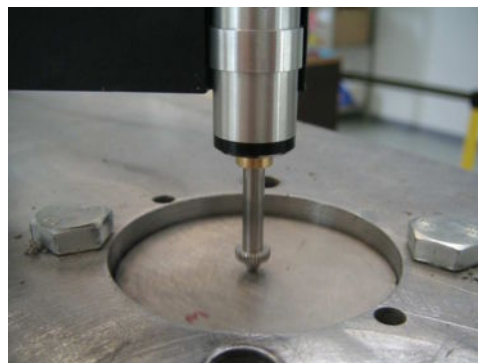
Figure I.2 – Photo de la mesure de l'enfoncement de la masse durant un essai de fluage
