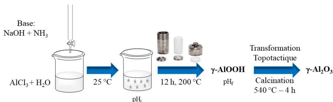
Figure 65: Protocole de synthèse par précipitation à partir de sels d'aluminium avec ajout d'un mélange de base 9 .
