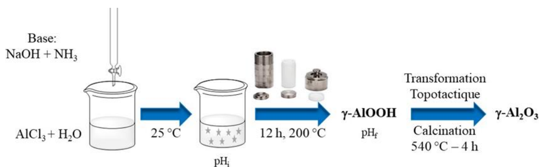
Figure 38: Protocole de synthèse hydrothermale par précipitation de sel d'aluminium à pH acide
