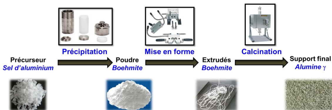
Figure 1: Schéma illustrant les différentes étapes nécessaires à l'obtention d'un support catalytique, ici l'alumine gamma.
