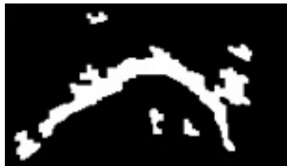
Figure 33 – Exemple d'image utilisée en entrée de l'algorithme automatique de détection de contours dont la sortie est utilisée comme contour initial. Cette image est obtenue après découpage de l'image, seuillage et filtrage. La sélection des régions recherchées pour l'extraction du contour utilise des connaissances a priori sur la physiologie de la langue.
