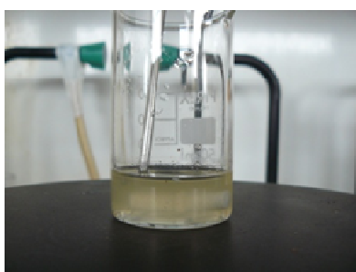
(a) Solubilisation de la fibroïne dans une solution de LiBr 9 mol/L
