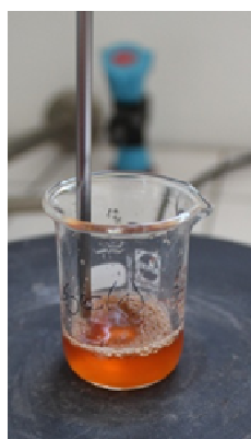
(a) Solubilisation de spidroïne dans une solution de LiBr 9 mol/L
