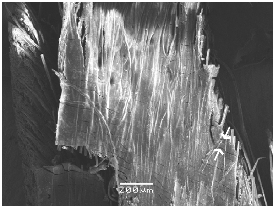
Figure 4.33 : Fissures de la matrice proches de la zone de rupture pour le composite 5 (groupe 2).
