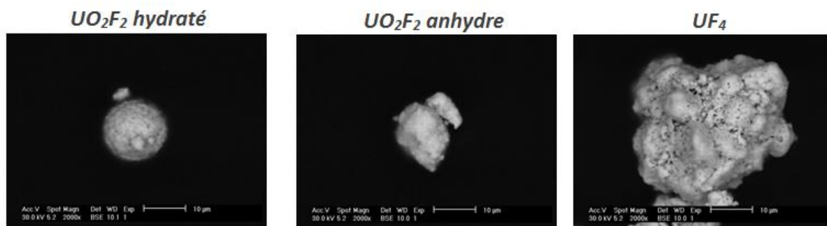
Figure IV-10. Exemple d'images électroniques de particules du matériau 2 analysées par spectrométrie micro Raman couplée à un MEB (FEI XL-30).
