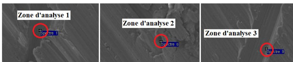
Figure II-13. Changement de la forme de rugosité en fonction de la zone d'analyse pour un échantillon de Ti.
