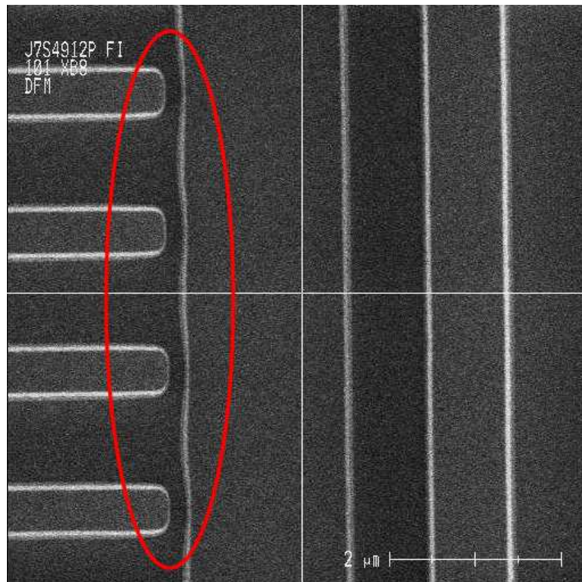
Figure 11 : Défaut systématique généré par des règles de correction de proximité trop agressives
