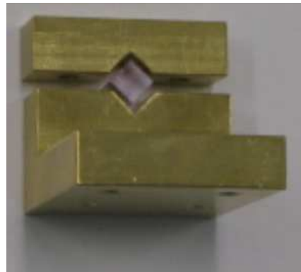
Figure III - 22 : Photo du support échantillon en laiton avec un échantillon de verre phosphate dopé néodyme.
