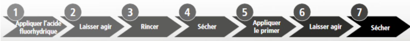
Figure 26 : Comparaison du nombre d'étapes nécessaires à un conditionnement conventionnel (AF /silane) ou avec le MEP
