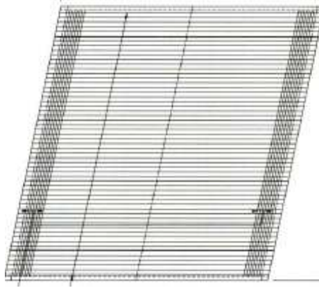
Figure 21) . Principe de disposition des armatures longitudinales
