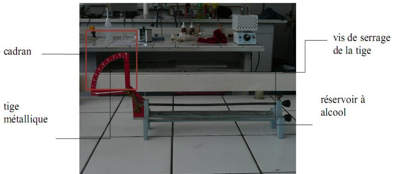
Figure 12a : dilatomètre à cadran ( http://www.joel-houzet.fr/cours/tp/tp_dilatometrie.pdf )
