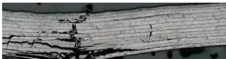
FIGURE 3.4: Exemple d’une micrographie issue d’un essai d’indentation statique sur un stratifié thermoplastique.
