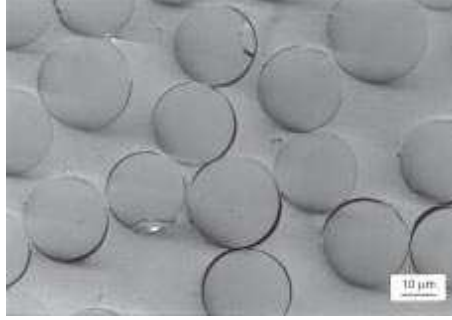
FIGURE 2.3: Décohésion fibre/matrice [Sjörge et Berglung (2000)].
