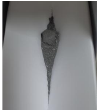
Figure 121 : Formation d'un bouchon (comprimé de poudre) observé suite à l'éjection de la poudre
