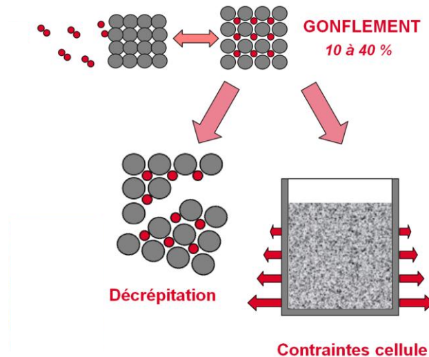
Figure 19 – Présentation schématique des principales conséquences du gonflement des hydrures lié à l'absorption d'hydrogène
