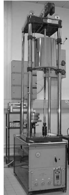
Figure A2-4 : Machine de fluage à poids mort.
