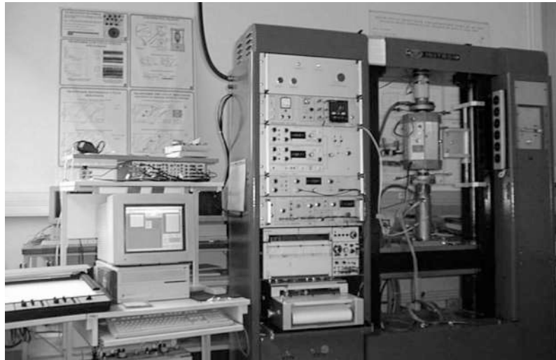
Figure A2-6 : Un des dispositifs expérimentaux de fatigue et fatigue-fluage.
