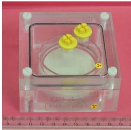
Figure VI-11. Photo d'une cellule de diffusion entrante en <sup>152</sup>Eu.
