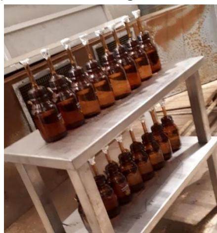
*Figure III-7. Prise de vue après irradiation des flacons en verre borosilicaté contenant les solutions alcalines additionnées de SP mises en équilibre avec du mortier CEM I broyé.*
